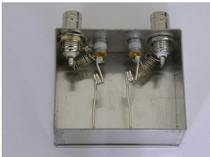
**Figura 2:** foto filtro L – C per i 435 MHz vista lato opposto ai connettori
