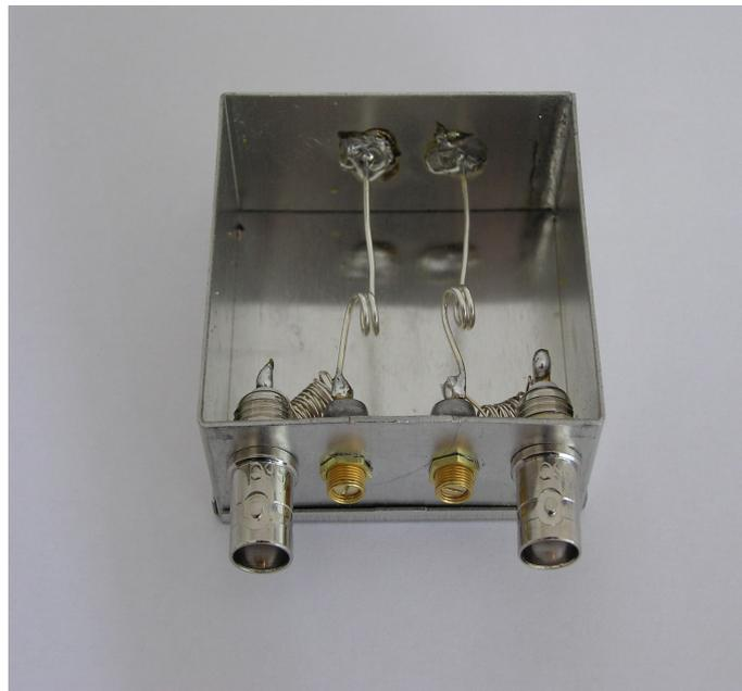
**Figura 1:** foto filtro L – C per i 435 MHz vista lato connettori
