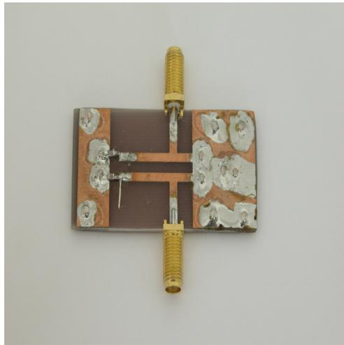
Figura 8: foto del filtro in microstrip per i 23 cm
